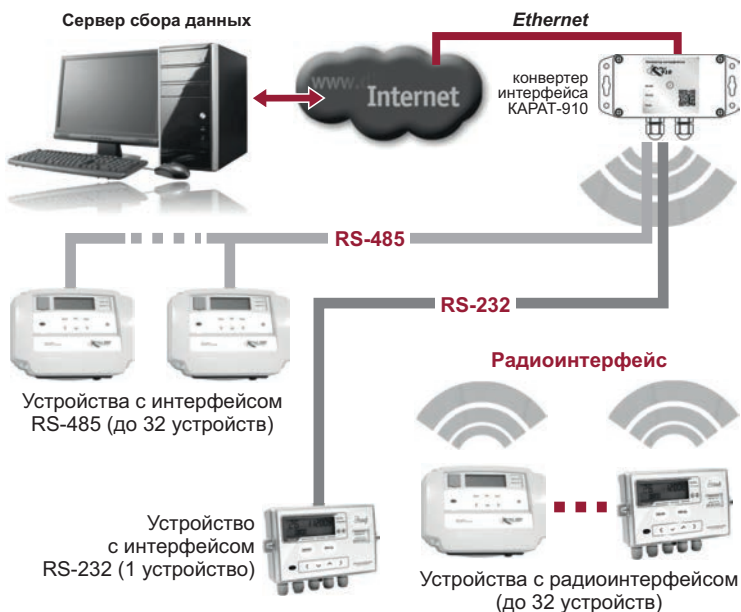
Рисунок 4 – Коммуникационные возможности конвертера
